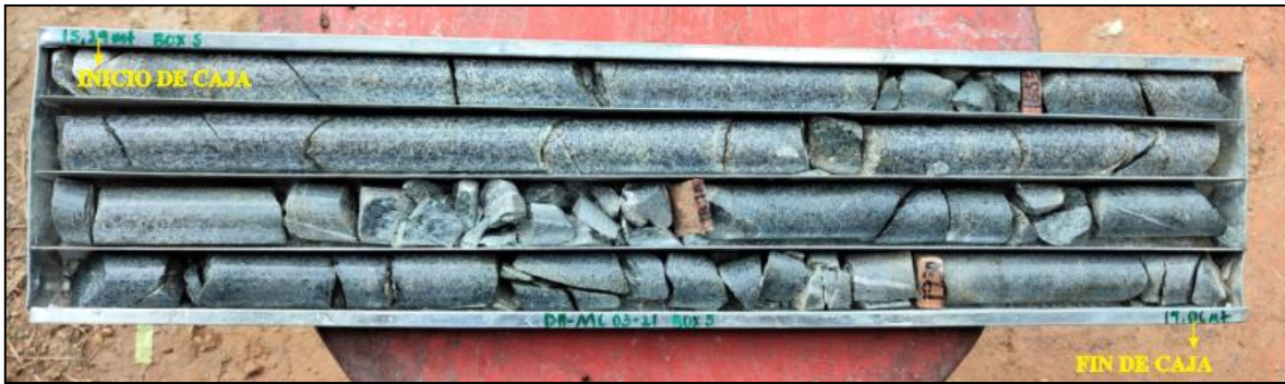
Figura 31: ejemplo de caja marcada con el inicio y fin de caja (Core box).
