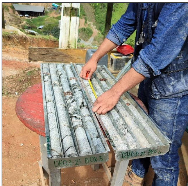
Figura 32: proceso de medida de recuperación física de núcleos.
