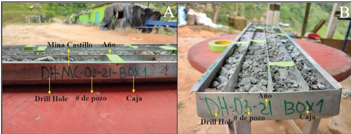
Figura 30: A) vista de la marcación frontal de caja porta testigos; B) vista de la marcación lateral caja porta testigos.
