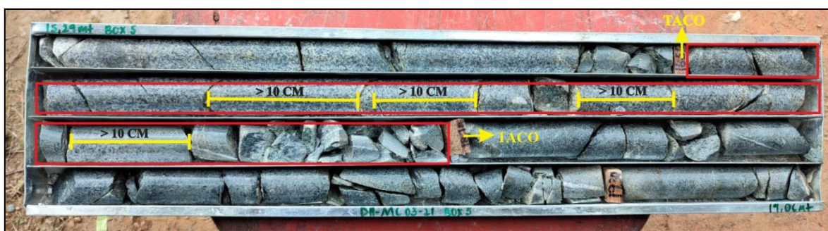
Figura 33: descripción de procedimiento de medida de RQD en núcleos de perforación.
