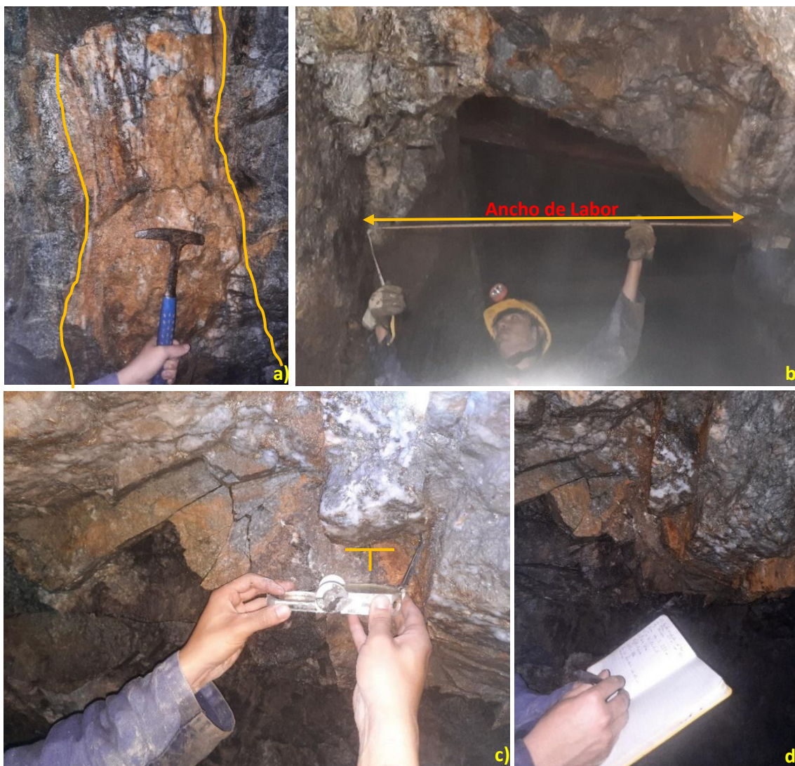
Figura 34. Ejemplo de caracterización de estructuras mineralizadas; a) Veta a caracterizar, localizada en el bloque #7; b) Toma de medidas del ancho de labor, de veta y falla; c) toma del dato estructural de la veta; d) descripción del frente: Muestra de veta tomada a techo en el bloque #7, del metro 3 al 6.4 desde el frente de la sobre guía al este. El sulfuro se presenta en una proporción de 12%, en forma masiva y en cristales; la estructura contiene 5% de oxidación. De norte a sur; 0.13 de granodiorita, veta de 0.32m, 0.23m de granodiorita con 8% de alteración potásica, veta de 0.05m, 0.12m de granodiorita, 0.03m de falla, 0.05m de granodiorita, 0.02m de veta y, el resto es granodiorita.
