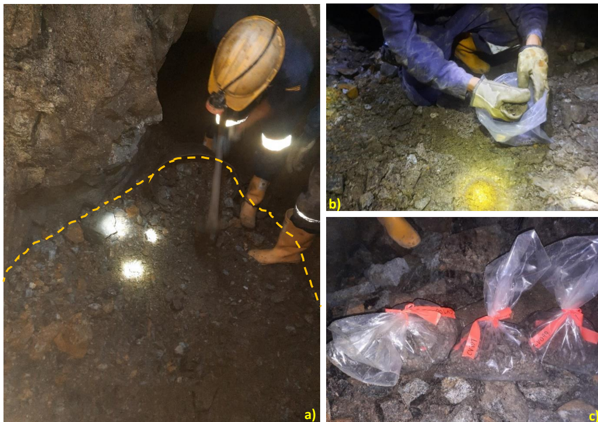
Figura 30. a) Compósito de voladura producto de la explotación del bloque #8; b) toma de muestra; c) muestras listas para sacar a superficie y ser procesadas en laboratorio.
