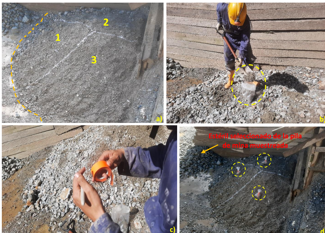
Figura 31. a) División de la pila en tres porciones para ser muestreada; b) toma de muestras; c) se marca la cinta con el consecutivo respectivo; d) muestras tomadas en cada porción, listas para ser procesadas en el laboratorio.
