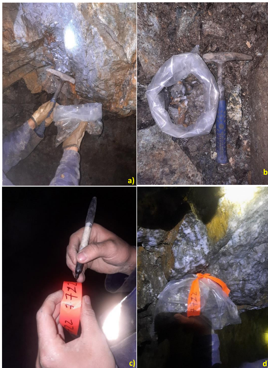
Figura 29. a) Extracción de una porción de muestra que represente la totalidad de la veta; b) muestra en una proporción de 3 kilos de veta; c) se marca la cinta con el respectivo consecutivo; d) muestra lista para sacar a superficie y ser procesada en el laboratorio.
