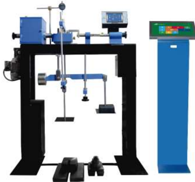
Figura 35. Aparato de corte directo en suelos (Pinzuar.com.co). De manera similar al aparato de compresión mostrado en la Figura 33, la máquina de corte imprime un esfuerzo de 5 o 50 KN a velocidad controlada pero en dirección tangencial haciendo un efecto de “corte”. Para este caso se debe repetir el ensayo tres veces con cargas diferentes. Un programa registra la deformación ocasionada por cada esfuerzo.
