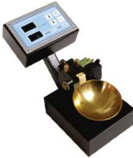
Figura 30. Cazuela de Casagrande (Pinzuar.com.co). La cazuela o cuchara de Casagrande puede ser electrónica o manual, en cualquier caso, deberá estar calibrada de tal manera que la altura de caída sea de aproximadamente un centímetro.
