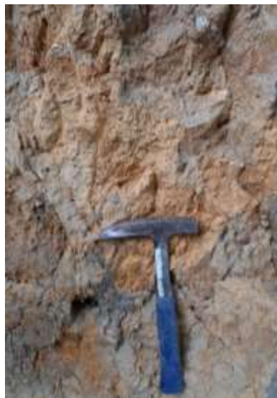
Figura 40. Formación superficial encontrada en SCB-2. El tamaño de grano sigue siendo lapilli, sin embargo, los granos no son tan notorios como en SCB-1. Se evidenció un leve aumento en la humedad, lo que permite inferir que, en este tipo de depósitos, entre más fino el material, más capacidad de absorción y adsorción de agua se tiene.
