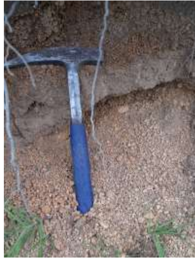
Figura 39. Formación superficial encontrada en SCB-1. Se observa el tamaño de grano lapilli en el suelo encontrado, por ser un tamaño relativamente grueso, no presenta plasticidad. La humedad es también baja.
