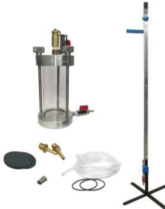
Figura 32. Equipo de permeabilidad (Pinzuar.com.co). En la esquina superior izquierda se presenta el permeámetro que consta de dos válvulas: una de entrada y una de salida, y de un frasco de plástico de tres pulgadas de diámetro insertado en un esqueleto metálico. Debajo del permeámetro se muestran los accesorios: una manguera de un tercio de pulgada de diámetro, dos válvulas, dos piedras porosas, un resorte y dos cauchos que ayudan a cerrar el permeámetro. En la derecha se muestra el manómetro que para este caso es una regla de un metro de longitud.
