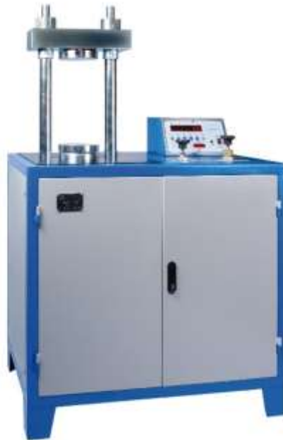
Figura 33. Aparato de compresión inconfiada en suelos(Pinzuar.com.co). El aparato imprime una fuerza axial de 5 o 50 KN, y avanza a una velocidad controlada. Mientras tanto, se registran las deformaciones verticales ocasionadas por diferentes magnitudes de esfuerzo.
