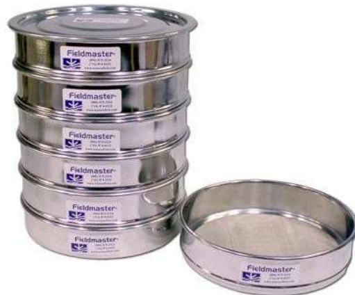
Figura 28. Serie de tamices (Colombia.bioweb.co). Los tamices usados en el ensayo serán los números 4, 10, 20, 40, 60, 100 y 200, entendiéndose el número como la cantidad de agujeros que caben en una pulgada cuadrada, por ejemplo, el tamiz 10 involucra una malla en la cual, si se divide en una grilla de pulgadas cuadradas, cada celda tendrá 10 agujeros en su interior, La distribución de tamices puede variar pero debe ser tal que permita generar una curva granulométrica bien distribuida.
