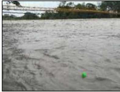
Figura 7. Método del flotador utilizado en campo.
